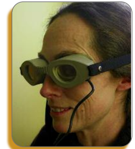
Figure 4 : Lunettes chauffantes à chambre humide (prototype développé par les laboratoires Théa)
