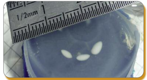
Figure 1 : Lésions obtenues dans un gel thermosensible avec des paramètres d'exposition de 6,9 \text{ W/cm}^2 , temps ON 6s, temps OFF 20s.
