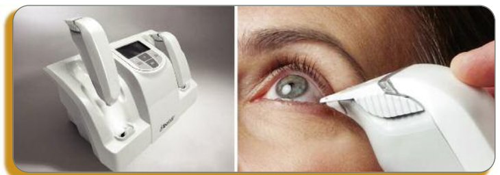
Figure 2 : Mesure de l'osmolarité lacrymale à l'aide du Tear Lab™
