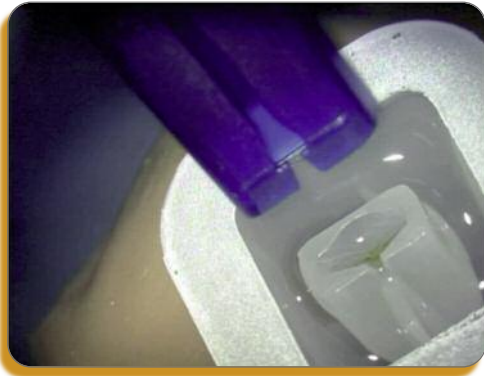
Figure 2 : Assemblage de l'injecteur sur la cartouche
